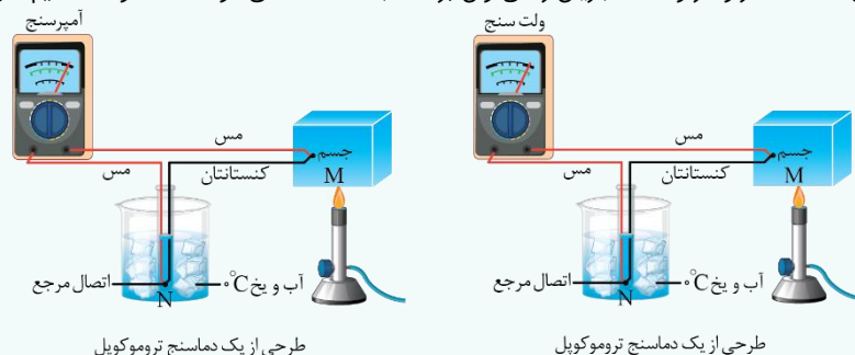
طرحی از یک دماسنج ترموکوپل
