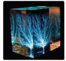
شکل ۱-۳۸ نقش های لیبنبرگ، فروریزش الکتریکی باعث تشکیل مسیرهای رسانای سرخسنگی در دی الکتریک شده است.
