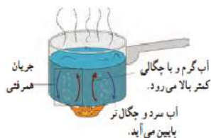
شکل ۴-۳۶ گرم شدن آب درون قابلمه به روش همرفت
