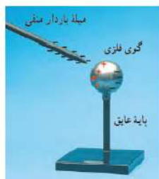
شکل ۱-۲۷ نزدیک کردن میله باردار منفی به گوی فلزی خنثایی که روی پایه عایقی قرار گرفته است. موجب ایجاد بارهای القایی مثبت و منفی در دو طرف گوی فلزی می‌شود.
