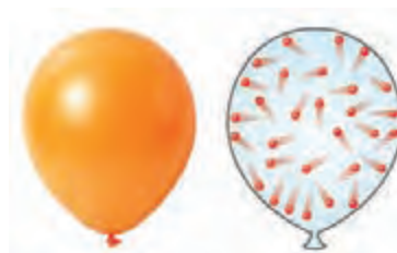
شکل ۲-۶ حرکت نامنظم ذرات گاز درون یک بادکنک
